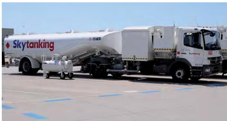
Solche Tankwagen kommen dort zum Einsatz, wo das Hydrantensystem nicht zur Verfügung steht. Die Fahrzeuge können auch selbst über den Anschluss an einen Hydranten betankt werden. Sie verfügen über eine Hebebühne mit zwei Bühnenschläuchen und zwei Schlauchtrommeln mit Abgabeeinrichtungen für kleinere Flugzeuge.
